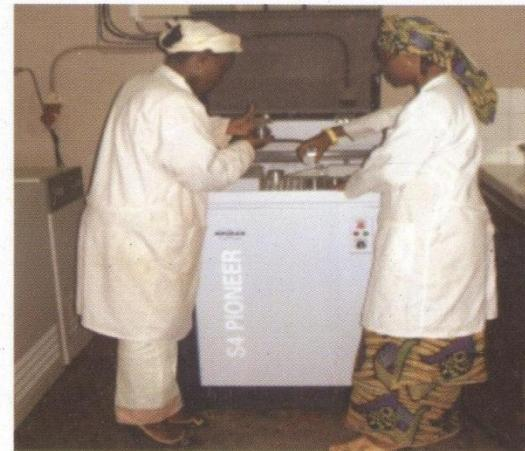
C'est une technique d'analyse qui permet d'identifier et quantifier les éléments chimiques du tableau de classification périodique (Be à U) présents dans un échantillon donné.
